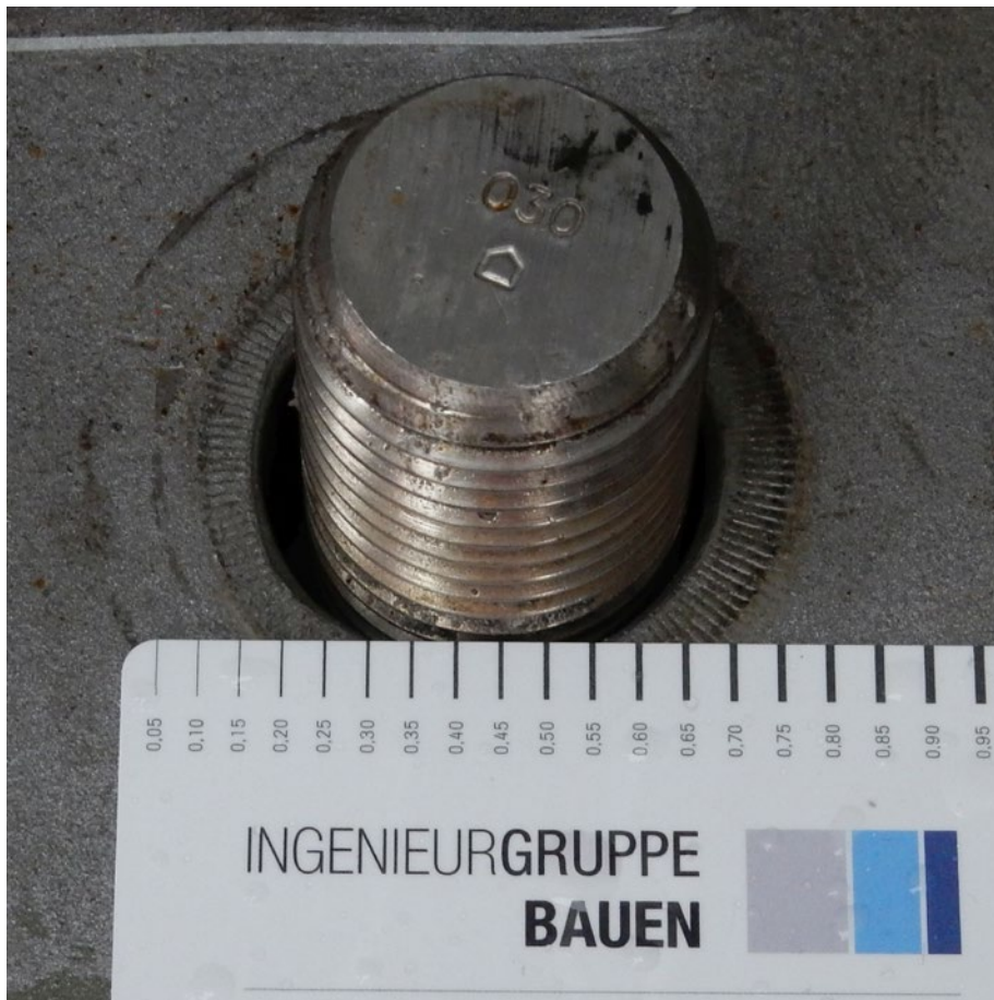
Abb. 4: Die Struktur der Keilsicherungsscheiben prägt sich durch das Vorspannen ins Grundmaterial ein.
